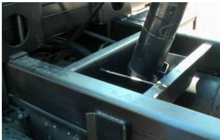
Рис. 2 Нижняя опора гидроцилиндра подъема кузова (корзина) Рис. 3 Система защиты от опрокидывания кузова
