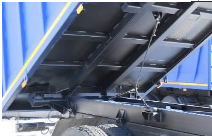
Рис. 2 Нижняя опора гидроцилиндра подъема кузова (корзина) Рис. 3 Система защиты от опрокидывания кузова
