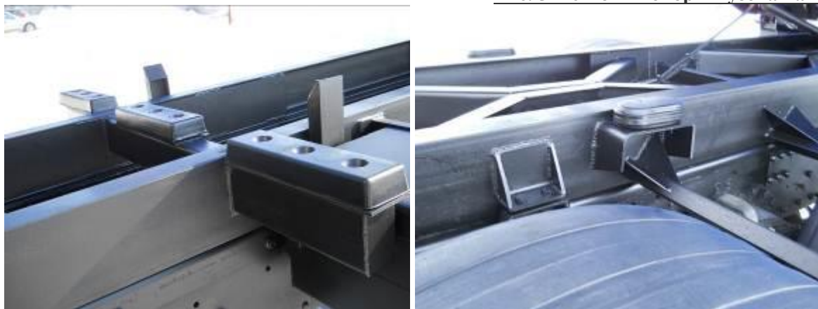
Рис. 5 и 6 Точки опоры кузова на надрамник.
